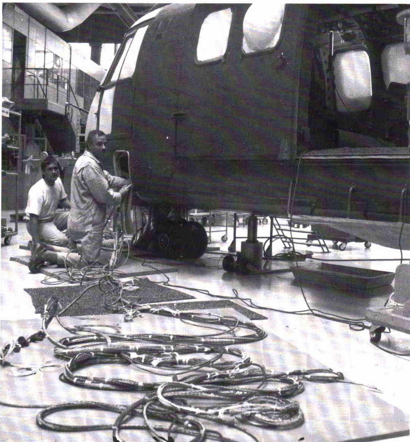
Efter monteringen på kablagebordet sker installation i helikoptern.
